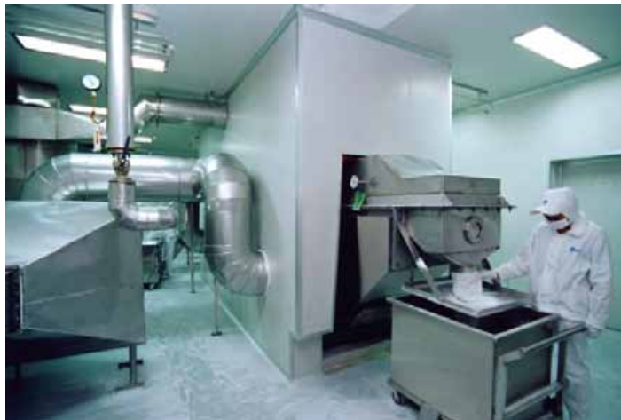
实际使用中的ZLG系列振动流化床干燥机
